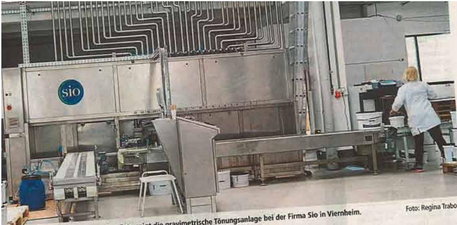
... einer perfekten Farbmischung. Das Foto zeigt die gravimetrische Tönungsanlage bei der Firma Sio in Viernheim.
